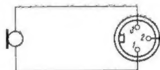
Rys. 2. Schemat połączeń mikrofonu MDO-VIII
