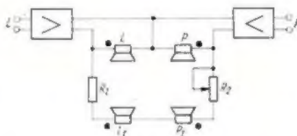
Rys. 3. Schemat strukturalny układu pseudokwadrofonicznego realizowanego za pomocą dwóch głośników dodatkowych
