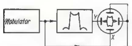
Rys. 2. Układ do pomiaru charakterystyk metodą generatora dewiacyjnego
